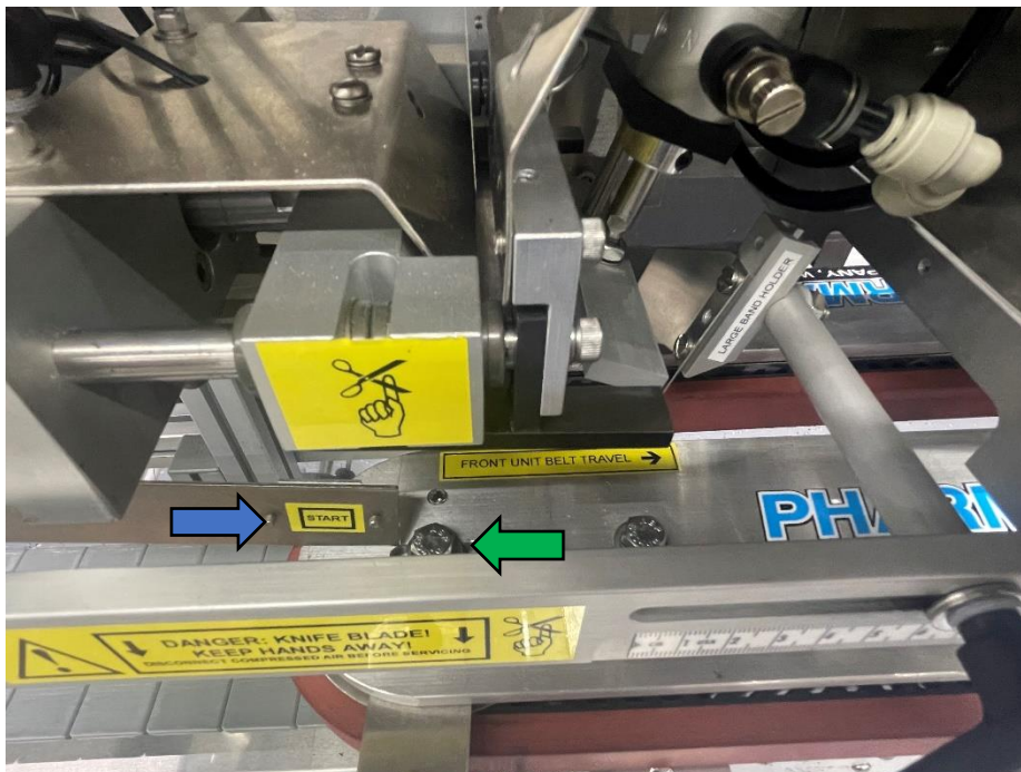
Fig.2: Colocación típica del sensor de arranque NB1 (azul) en el tornillo de tensión de la correa delantera BCV2 (verde)
