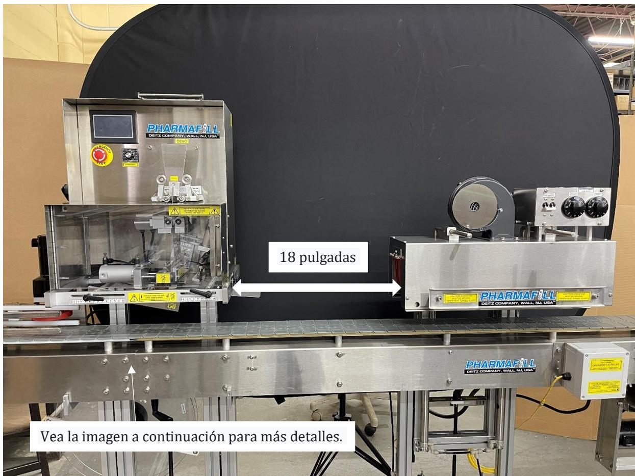
El túnel de calor siempre debe estar en el extremo del motor (sección de arranque) del transportador. Las tiras de desgaste de latón están diseñadas ÚNICAMENTE para reemplazar las tiras de desgaste estándar en una sección de arranque de seis (6) pies de largo. Mientras la cinta transportadora está en constante movimiento, las tiras de desgaste permanecen estacionarias. El latón puede soportar altas temperaturas, pero la tira de desgaste estándar se derretirá, o algo peor.
